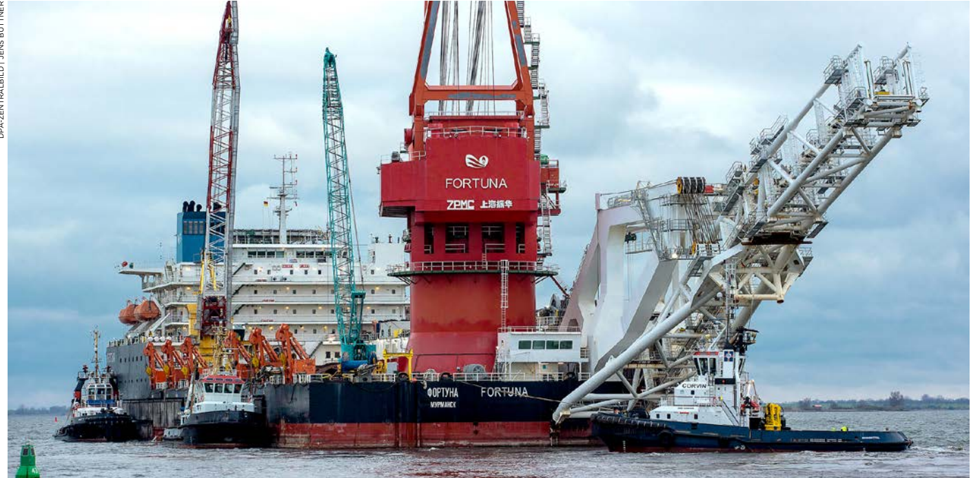
Das russische Verlegeschiff Fortuna wird für Bauarbeiten an der deutsch-russischen Ostsee-Gaspipeline Nord Stream 2 eingesetzt
